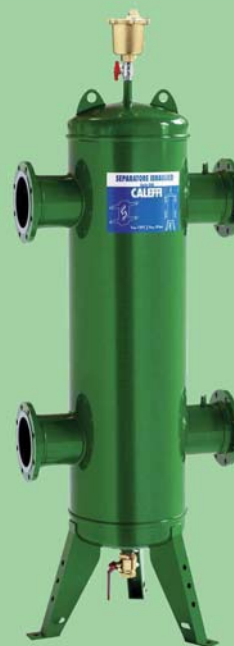
SEPARATOR HIDRAULIC DIN OTEL, CU DEZAERATOR SI ROB GOLIRE, IZOLAT Q=2.5MC/H, 1", 42548006
