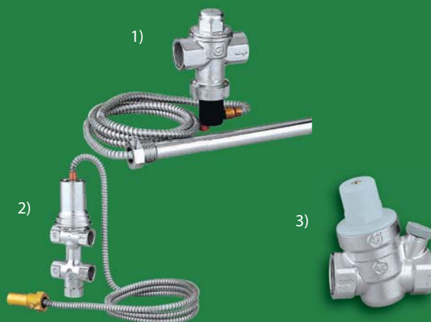
• 1) VALVA DESCARCARE DE SIGURANTA 3/4", 42543513; Pentru cazane de agent termic pe combustibil solid; senzor de temperatura; temperatura de descarcare: 95°C.
